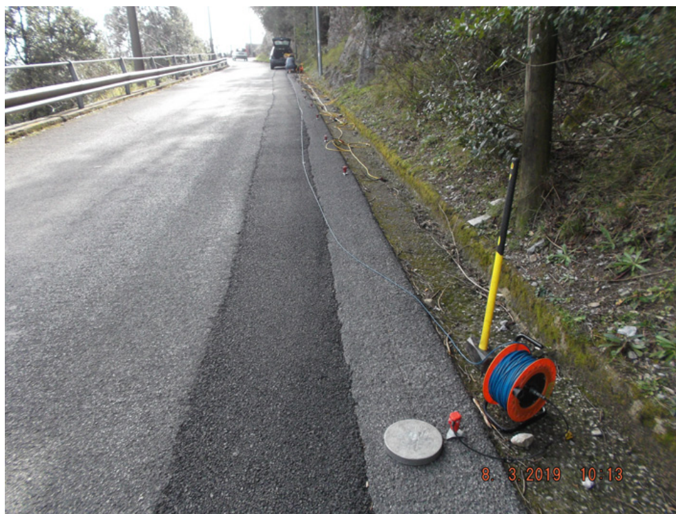
Figura 10: stendimento sismico della prova sismica MASW
