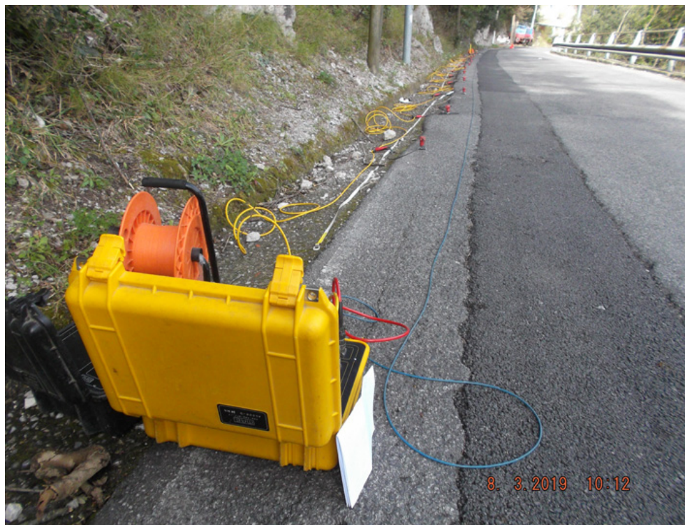
Figura 9: prova sismica MASW eseguita il 08.03.2019 sulla via comunale per Sambuco
